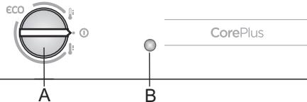
**A Переключатель ВКЛ./ВыКЛ. прибора, установки температуры, режима ЕСО и функции «Быстрое охлаждение и замораживание»**
