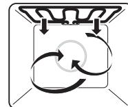
Нагрев осуществляется с помощью нагревательного элемента гриля. Воздух в камере прибора циркулирует равномерно за счет нагнетателя горячего воздуха.
