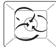
Воздух в камере нагревается нагревательным элементом, расположенным за задней стенкой камеры, и равномерно циркулирует.
